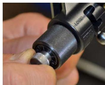
La perilla de ajuste de altura de la cuchilla es fácil de leer y agarrar para lograr cortes rápidos y precisos.
