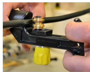
El diseño del mango "T" mejora el apalancamiento y la ergonomía durante cortes longitudinales o de anillo.
